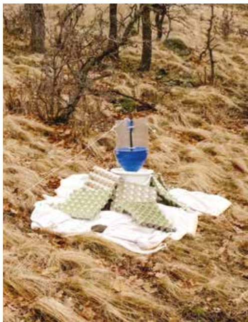
V. 24. ábra: Hordozható fénycsapda (vödör-csapda) (fotó: Korompai Tamás)
