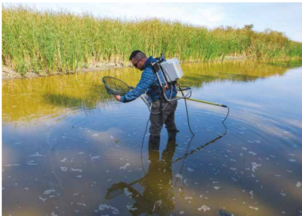
VI. 5. ábra: Elektromos halászgéppel, gázolva történő mintavétel
